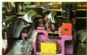
Trekken, stansen, afkanten; het plaatstaal doorloopt meerdere productiefasen.
