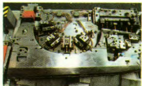
Wisseling van werktuig in de perserij! Als de vormen niet op de millimeter nauwkeurig zijn, ziet men dat aan de auto.
