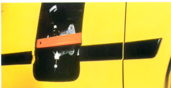
Door toepassing van in de portieren geïntegreerde veiligheidsbalken kan de vormvastheid der portieren in bepaalde botsituaties worden verdubbeld.
