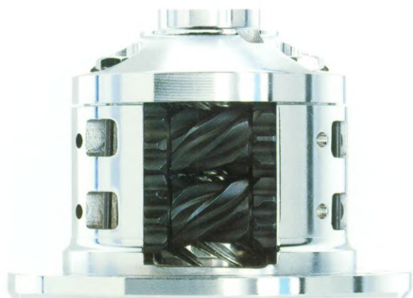
Het TORSEN-tussendifferentieel regelt het aandrijfkoppel automatisch en variabel.
