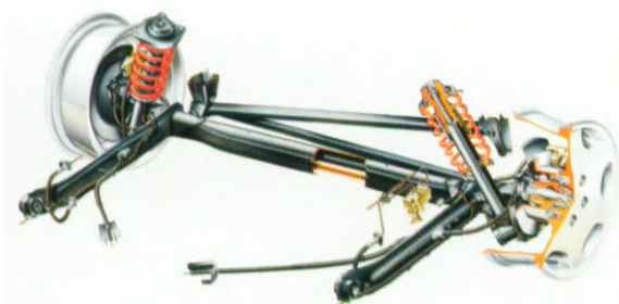
Met behulp van de computer werden de kinematische eigenschappen van de vooras geoptimaliseerd.
