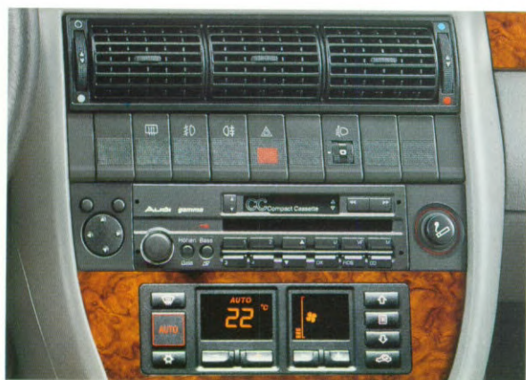
De bedieningselementen voor verwarming en ventilatie.
