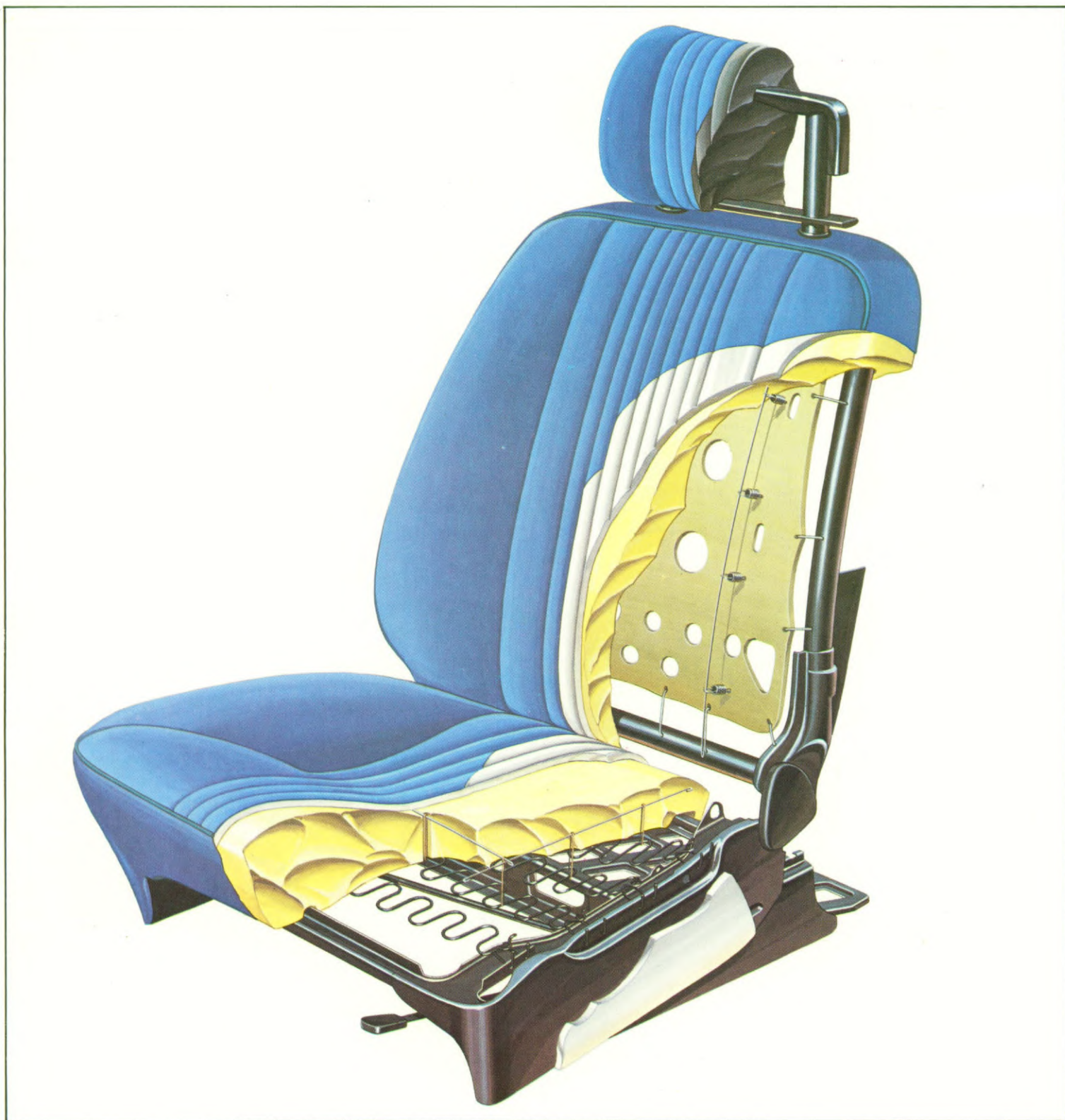
De stoel van de Alfetta: metalen structuur met stalen veren en met vullingen die het gewicht van de bestuurder verdelen en daardoor een zeer goed comfort bieden.
