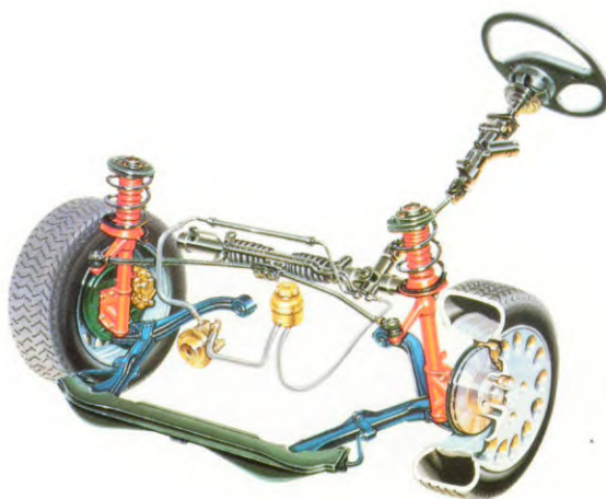
Voorwielophanging en hydraulisch bekrachtigde stuurinrichting
