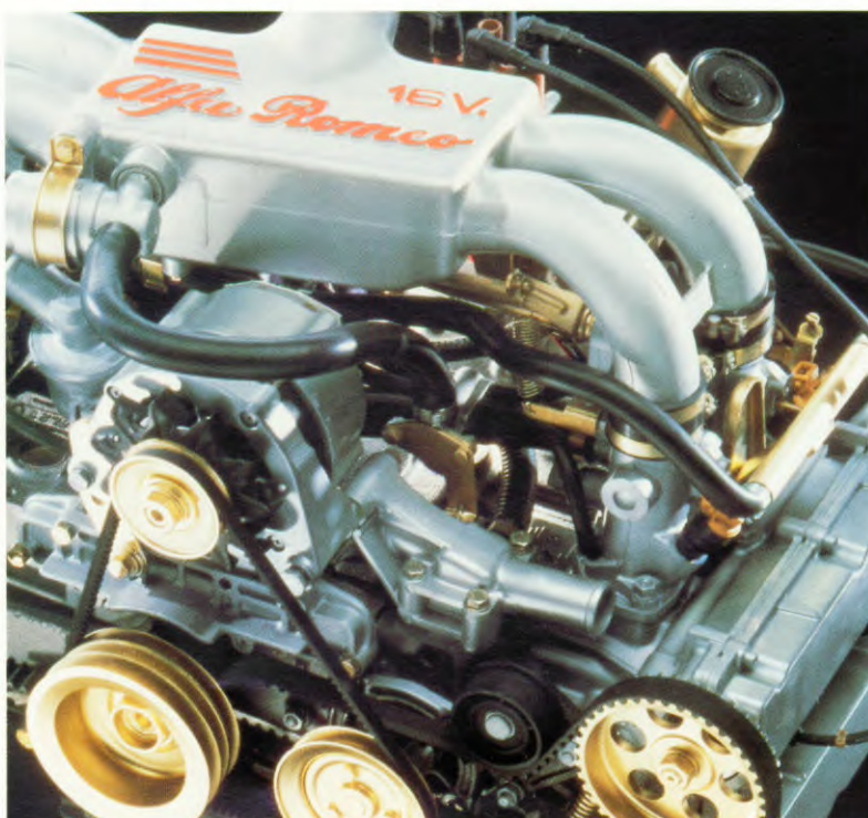
Detail van het distributiesysteem met vier kleppen per cilinder
