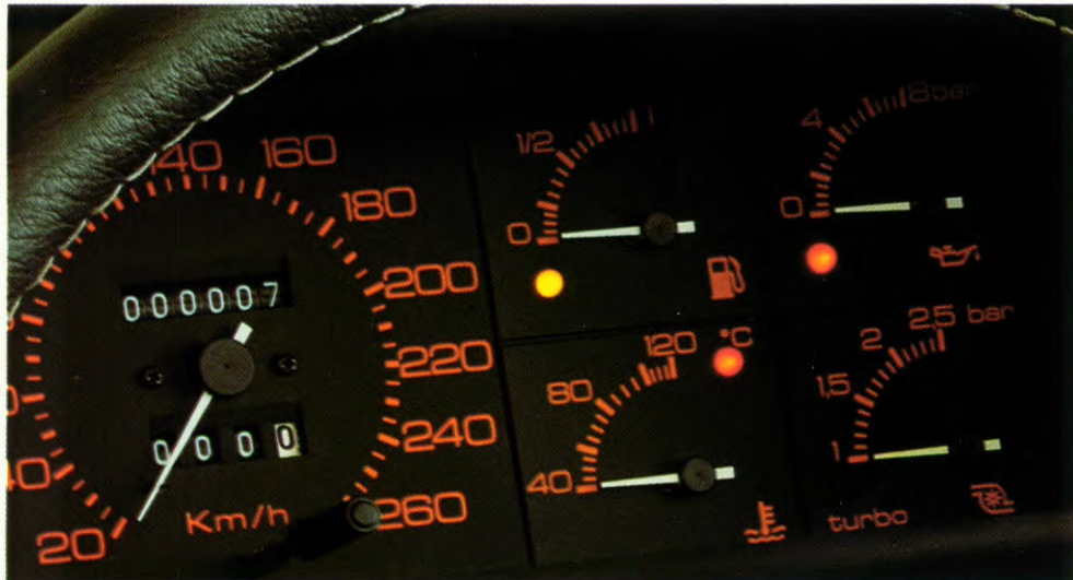
Het instrumentarium van de 1.8 Turbo America bevat tevens een turbodrukmeter.
