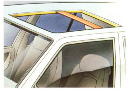
De dakbekleding van brandvertragend, gevormd glasvezelmateriaal vormt een effectieve bescherming bij een botsing.
