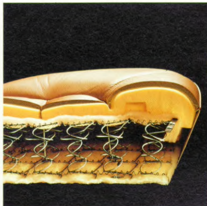
Het zitkussen van de achterbank bestaat uit meer dan 400 veren – het ontwerp is gelijk aan dat van een zeer exclusieve fauteuil.
