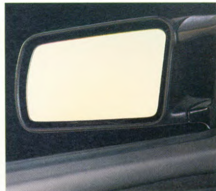
Grote, gestroomlijnde buitenspiegel aan de bestuurderszijde gedeeltelijk uitgevoerd als groothoekspiegel (niet op alle markten leverbaar). Het groothoekgedeelte is duidelijk aangegeven door middel van een lijn op het glas. Deze constructie heft de dode hoek volledig op.
