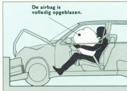
40 milliseconden na het moment van de botsing is de airbag bijna volledig opgeblazen. Het grootste deel van de kreukelzone is nu in elkaar gedrukt. Op dit moment begint de dummy als gevolg van de botsing naar voren te bewegen.
