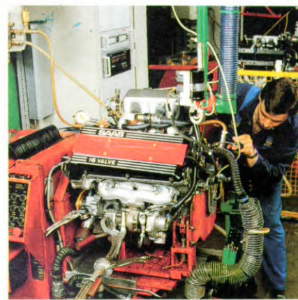
Iedere motor wordt proefgedraaid voordat hij de fabriek verlaat. De werking en de instellingen worden gecontroleerd.
