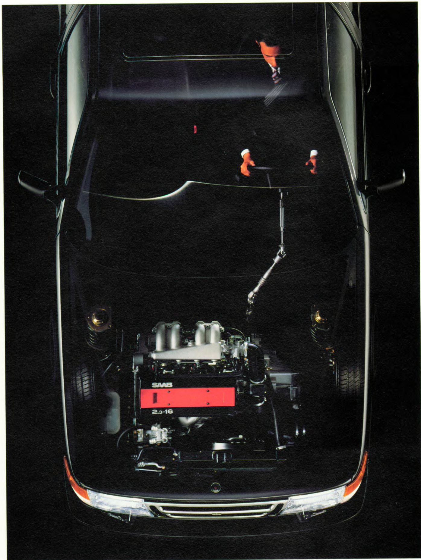
De Saab 9000 is uitgerust met voorwielaandrijving en een dwarsgeplaatste motor. Deze geïntegreerde krachtbron is derhalve uiterst compact en neemt slechts een zeer klein deel van de totale inhoud van de auto in beslag.
