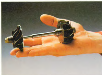
De Saab turbolader heeft geringe roterende massa's waardoor hij snel reageert en al bij een laag toerental begint te laden.
