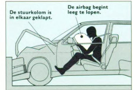
Er zijn 70 milliseconden verstreken sinds het moment van de botsing. Door de kracht waarmee de dummy de airbag raakt ontsnapt het gas in de airbag via een aantal openingen. Op deze manier wordt de voorwaartse beweging van de dummy geleidelijk afgeremd waardoor het gevaar van verwondingen tot een minimum wordt teruggebracht. Zodra de airbag leeg is speelt deze geen rol meer in de bescherming van de inzittende.
