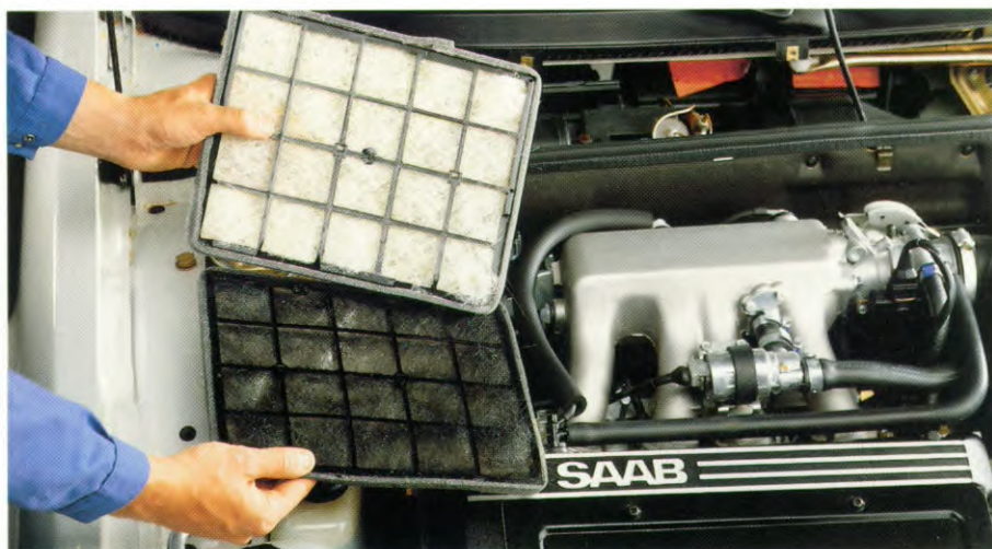
Daar het ventilatieluchtfiter in de Saab 9000 de meeste deeltjes met een grootte van 0,005 mm tegenhoudt, worden stof, stuifmeel en sommige bacteriën op effectieve wijze door het filter opgevangen. Het vervangen van het filter, dat slechts om de 30.000 km hoeft te gebeuren, is een eenvoudig karwei.
