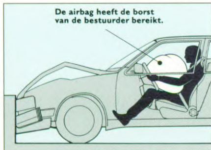
Na 23 milliseconden bereikt de airbag de borst van de dummy. Ongeveer de helft van de kreukelzone van de auto is nu ingedrukt. De dummy zit nog steeds op zijn plaats.
