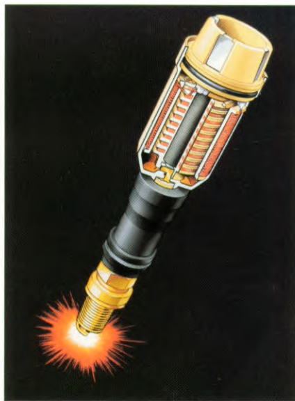
Eén ontstekingsbobine voor iedere cilinder. Verhoging van 400 tot 40.000 V.
