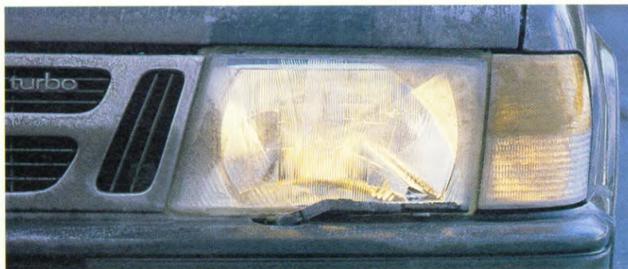
Saab kwam als eerste met koplampwissers als standaarduitrusting. De grote richtingaanwijzers die in de hoeklichtunits zijn opgenomen geven een duidelijk signaal aan andere weggebruikers.
