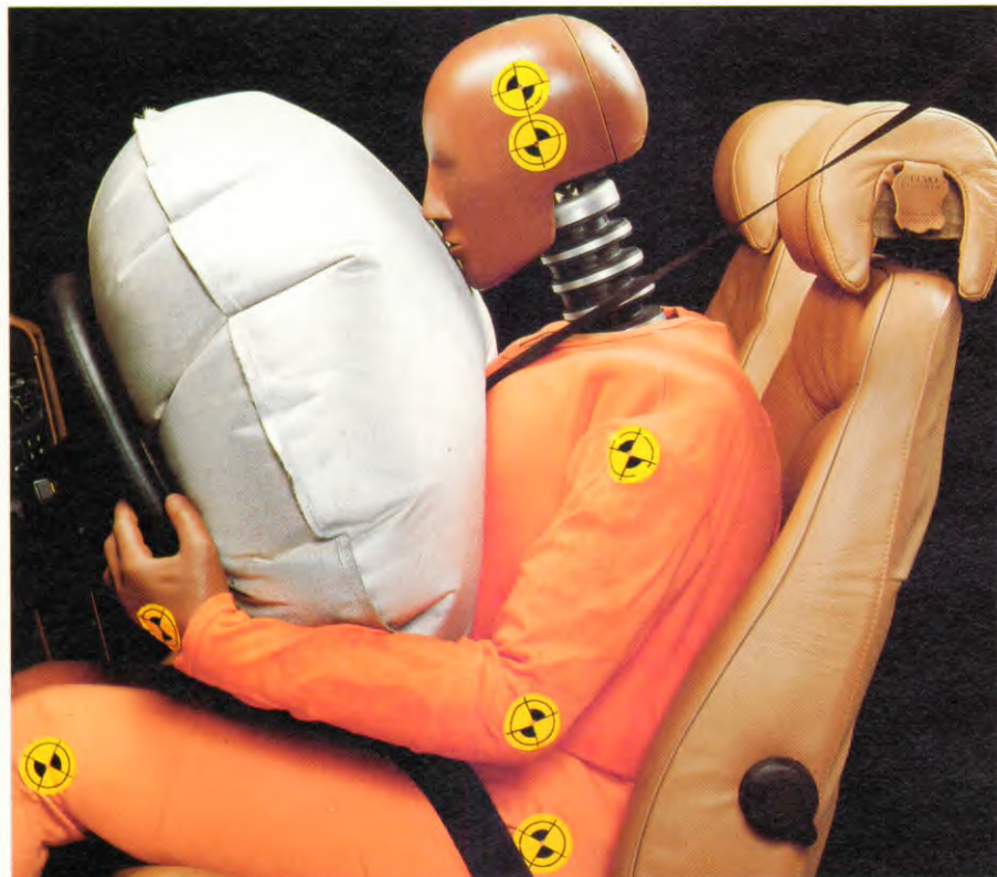
Het Supplemental Restraint System is ontworpen om de bestuurder die zijn veiligheidsriem draagt maximaal te beschermen. Het systeem dient niet ter vervanging van de veiligheidsriemen.
