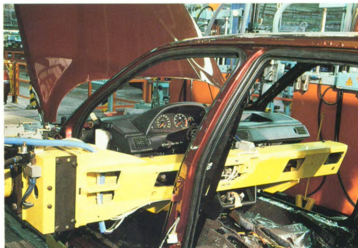
Het dashboard wordt volautomatisch door een robot in de carrosserie aangebracht
