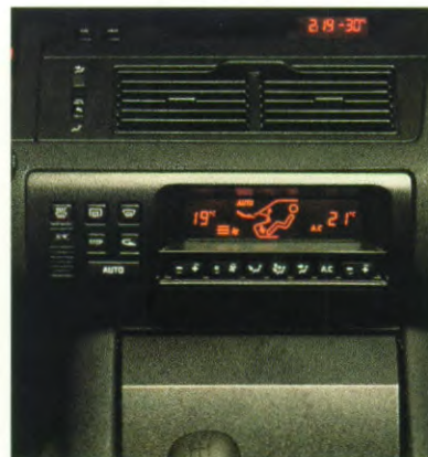
Airconditioning met elektronische temperatuurregeling.
