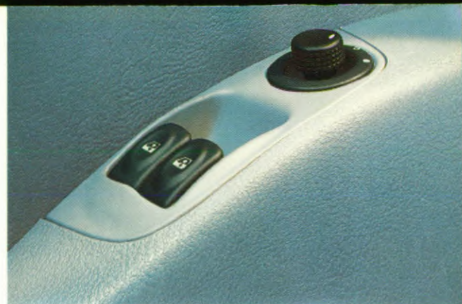
De bedieningsknoppen van de elektrisch bedienbare zijruiten vóór zijn voorzien van een veiligheidsmechanisme.
