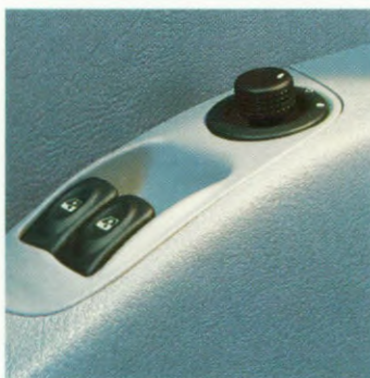
Elektrisch verstelbare en verwarmbare buitenspiegels met elektrisch bedienbare zijruiten voor
