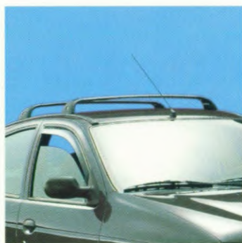
Allesdrager, complete set bestaande uit dwarsstangen, sierlijstset en een stelsleutel
