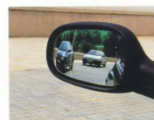
Linker buitenspiegel met asferisch glasoppervlak
