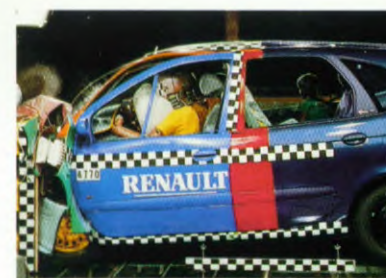
De nieuwe veiligheidshoofdsteun van Renault is optimaal afgestemd op de menselijke anatomie. Hierdoor daalt met name de kans op nekletsel bij een aanrijding van achteren. (afgebeeld met instelbare hellingshoek)
