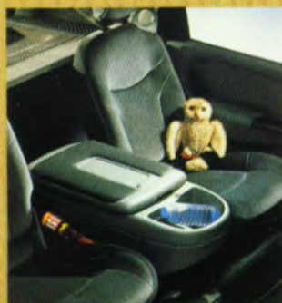
Multifunctionele module, opbergruimte-koelbox- tafel-armsteun
