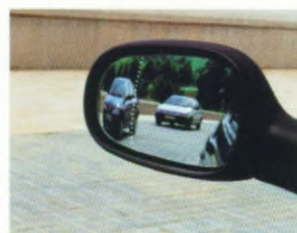
Linker buitenspiegel met asferisch glasoppervlak
