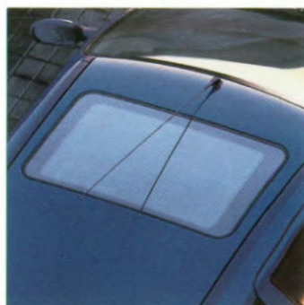
Elektrisch bedienbaar schuif-/kanteldak met zonnescerm
