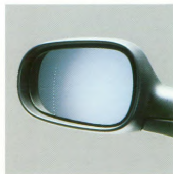
Elektrisch verstelbare en verwarmbare buitenspiegels (onderdeel comfortpakket)
