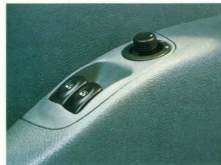
Elektrisch bedienbare buitenspiegels en zijruiten vóór
