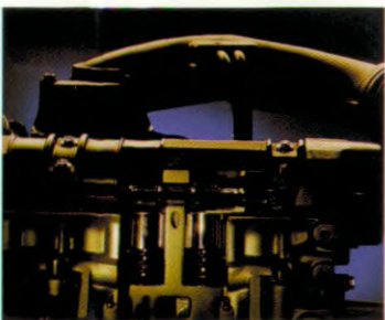
2.0 motor: 1998 cm 3 (115 pk) multipoint injectie
