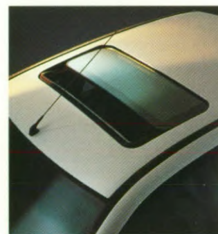
Elektrisch bedienbaar glazen schuifdak, gedeeltelijk geopend.
