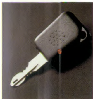
Centrale portiervergrendeling met in 2 sleutels geïntegreerde afstandsbediening.
