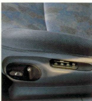
Elektrische verstelling voorstoelen met geboegen 3 posities bestuurdersstoel.
