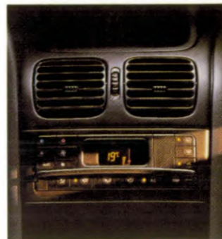
Airconditioning met elektronische temperatuurregeling.
