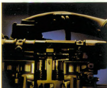
2.0 motor: 1998 cm 3 (115 pk) multipoint injectie
