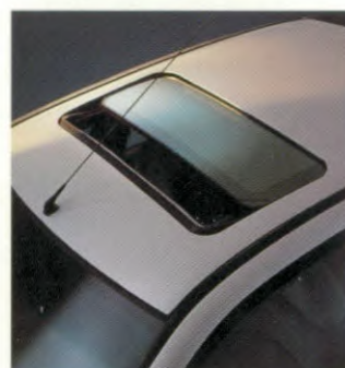
Elektrisch bedienbaar glazen schuifdak, gedeeltelijk geopend.
