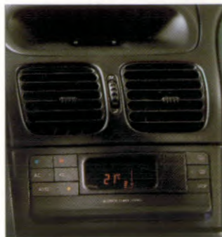
Elektronisch geregelde airconditioning
