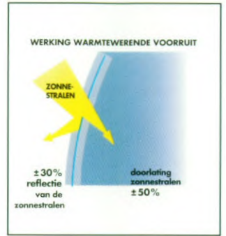
De warmteverende voorruit draagt bij aan een aangename temperatuur in de auto.
