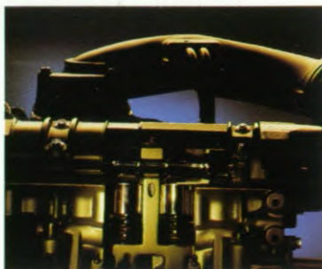
2.0 motor: 1998 cm 3 (115 pk) multipoint injectie
