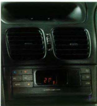
Elektronisch geregelde airconditioning
