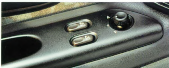
Bedieningsknoppen voor de elektrische bediening van de zijruiten vóór en het verstellen van de buitenspiegels, binnen handbereik in de armsteun van het bestuurdersportier (RT, RXE).
