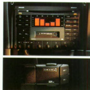
4x20 W Stereo radio/cassettespeler en CD-speler, met anti-diefstalcode en bedieningssatelliet aan de stuurkolom.
