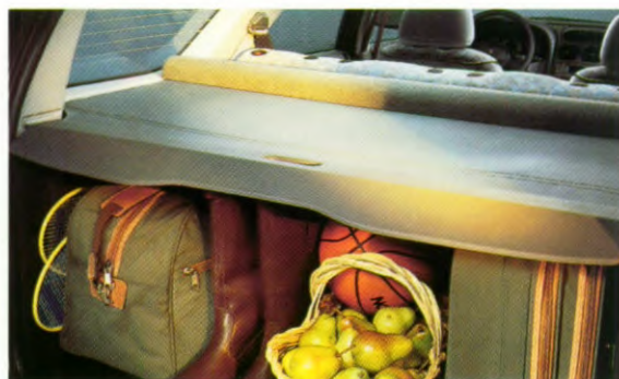
Achterklep, bagageruimte en bagagedek. Totale functionaliteit: de achterklep is in sommige uitvoeringen zelfs in twee delen te openen: achterraut alleen of achterklep compleet.
