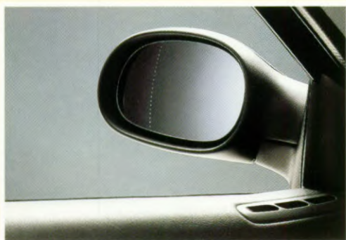
Linker buitenspiegel met asferische spiegel. Een groothoek ontwerp voor een maximaal zicht.
