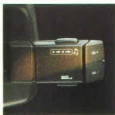
Radio met veilige en comfortabele bedieningssatelliet aan de stuurkolom (extra).
