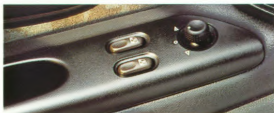
Bedieningsknoppen voor de elektrische bediening van de zijruiten vóór en het verstellen van de buitenspiegels, binnen handbereik in de armsteun van het bestuurdersportier.
