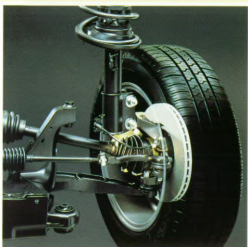
Mc-Pherson technologie. De voortrein absorbeert dwarskrachten en de hobbels van het wiel voor een excellente vering, stabiel weggedrag bij iedere snelheid en een grote koersvastheid.
