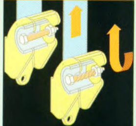
en ingebouwde krachtbegrenzers, om de kracht te beperken die de gordel uitoefent tijdens een botsing. Samenwerkende, innovatieve techniek.
