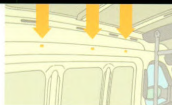
6 SCHROEFGATEN VOOR HET BEVESTIGEN VAN ACCESSOIRES IN HET INTERIEUR.
