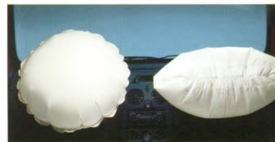
Airbag aan bestuurderszijde (60 liter) en passagierszijde (100 liter).
