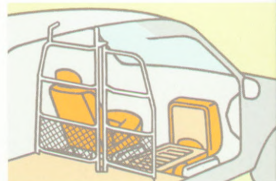
Door de zitting tot tegen de aanslag naar voren te kantelen en de rugleuning samen met de hoofdsteun naar beneden te klappen ontstaat een extra laadvloer.
