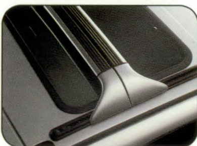
Dakrelings: dwarsstangen schuivend op rails in lengterichting.
