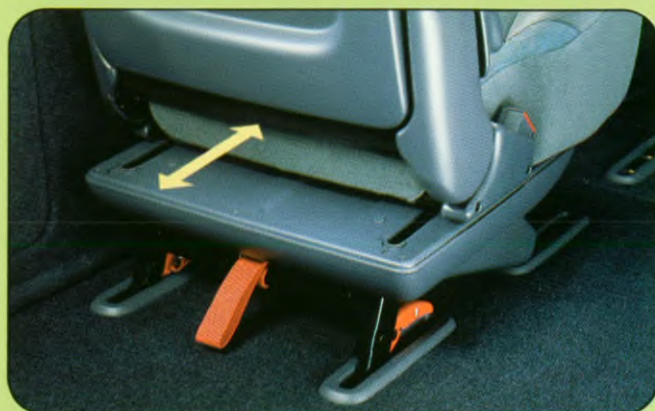
Systemen die de ruimte optimaal benutten. Dubbel verankerings-systeem in de vloer en glijders in het frame van de stoel.
