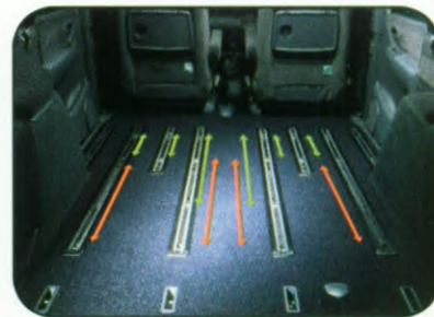
Super-functionaliteit achterstoelen door verstelmogelijkheden in vloerrails.
