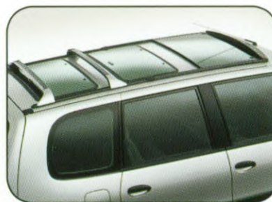
1 elektrisch bedienbaar glazen schuifdak + 2 handbediende kanteldaken.
