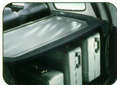
Uitneembaar bagagedek met rolhoes, te gebruiken met 5 en 7 zitplaatsen en op te bergen in de auto.
