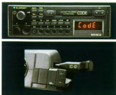
4x6 W stereo-installatie met cassettespeler en bedieningssatelliet aan de stuurkolom.
