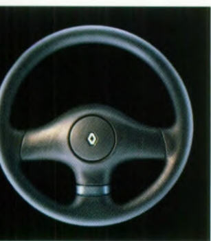
De naaf van het veiligheidsstuurwiel is gemaakt van dempend materiaal dat een verplaatsing van 70 mm kan opvangen.
