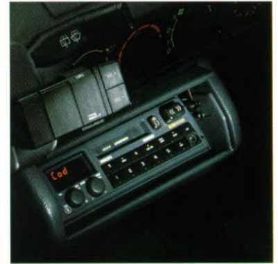
2x6 W stereo autoradio/cassettespeler met bedieningssatelliet aan de stuurkolom en antidiefstalcode.
