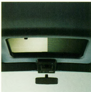
Elektrisch bedienbaar glazen schuif-/kanteldak met twee opklapbare zonneschermen.
