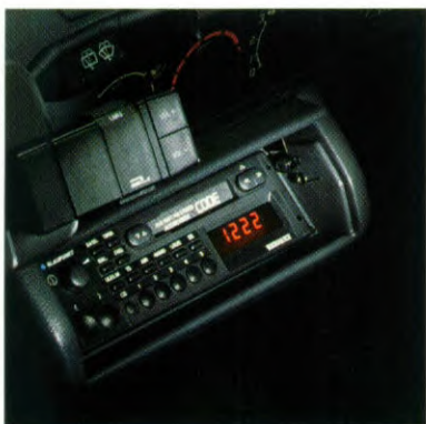
4x6 W stereo autoradio/cassettespeler met bedieningssatelliet aan de stuurkolom en antidiefstalcode.
