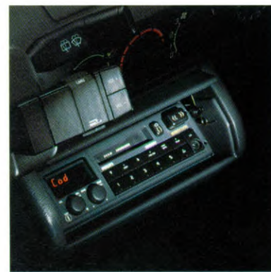
2x6 W stereo autoradio/cassettespeler met bedieningssatelliet aan de stuurkolom en antidiefstalcode.
