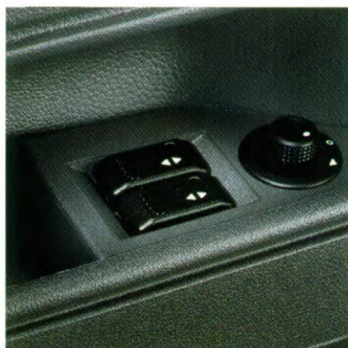
Elektrisch bedienbare portier-ruiten en snelschakelaar voor de bestuurdersplaats. (16V en Baccara) (onderdeel comfortpakket).
