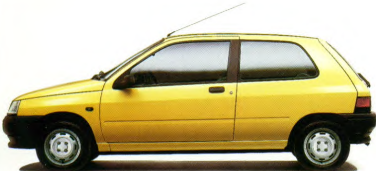
RL 1.2, 1171 cm 3 , 43 kW, 60 DIN pk U9, 3- en 5-deurs RL 1.9D, 1870 cm 3 , 47 kW, 65 DIN pk, 3- en 5-deurs
