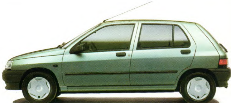
RN 1.2, 1171 cm 3 , 43 kW, 60 DIN pk U9, 3- en 5-deurs RN 1.4, 1390 cm 3 , 57,5 kW, 80 DIN pk U9, 3- en 5-deurs RN 1.9D, 1870 cm 3 , 47 kW, 65 DIN pk, 3- en 5-deurs
