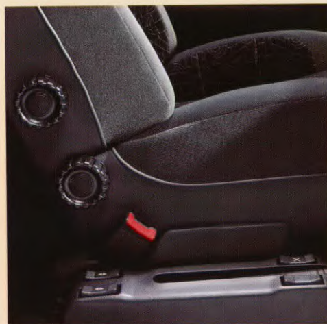
Verstelbare lendesteun in de rugleuning. Middenconsole met schakelaars voor het bedienen van de achterste zijruiten.
