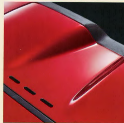
Ventilatie en verwarming van de achterraut.
