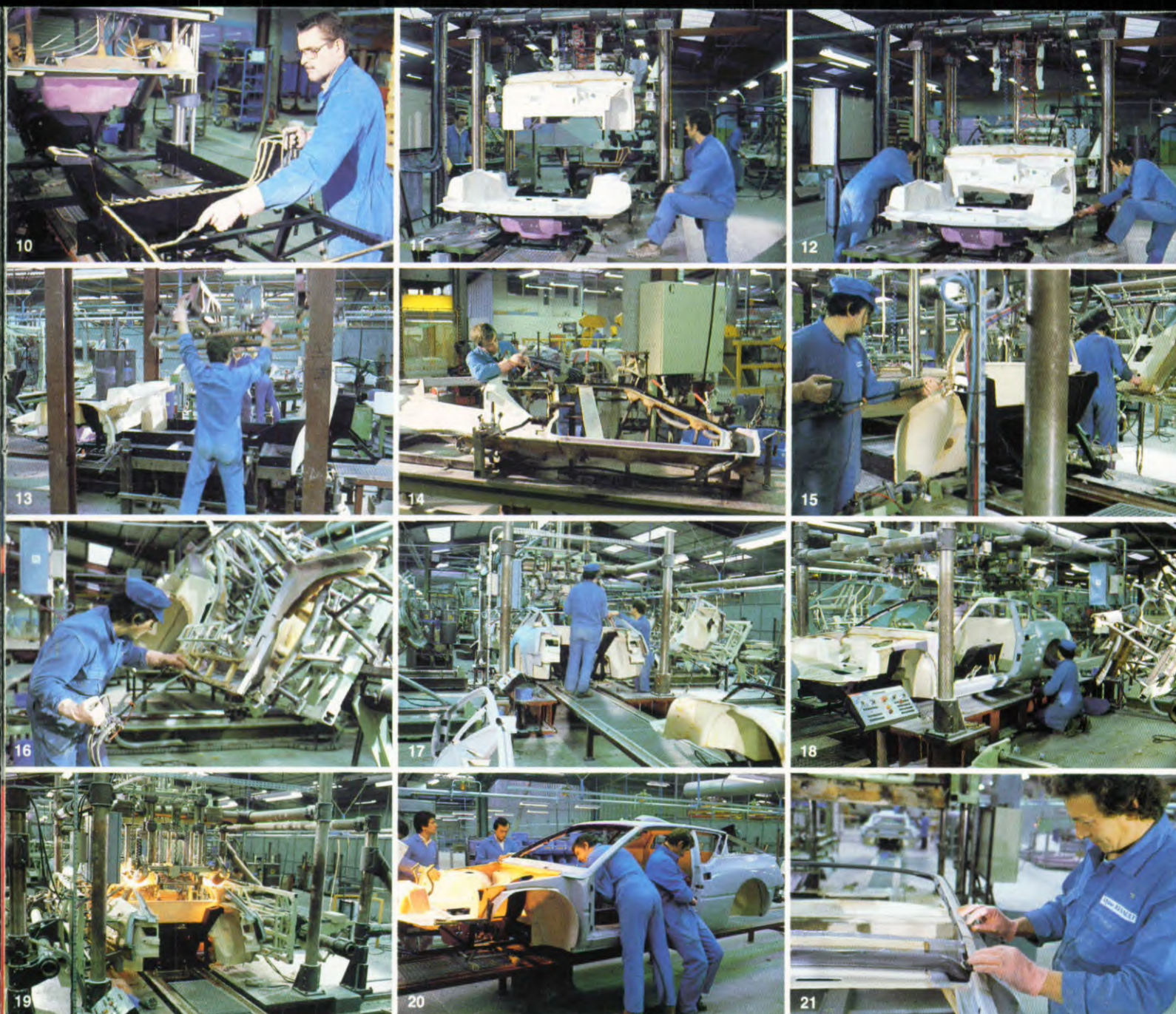
10 tot 21 Assemblage met behulp van structuurlijm. Aanbrengen van de lijm (10); montage onderbouw en schutbord (11-12); montage bodem (13); voorbereiding en montage zijkant: voorbereiding, op zijn plaats brengen en verlijmen van het dak; afwerking en controle (14 tot 20).
