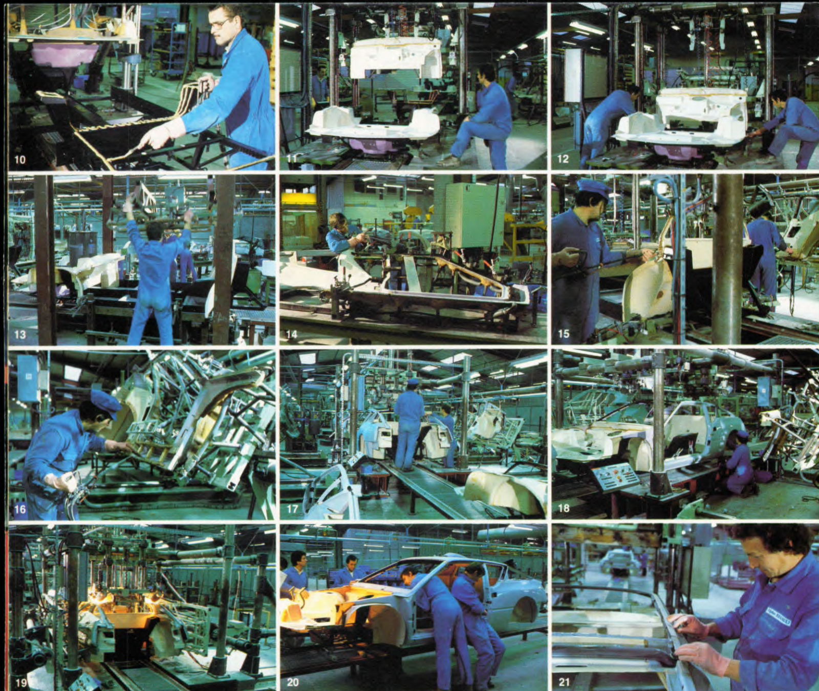
10 tot 21 Assemblage met behulp van structuurlijm. Aanbrengen van de lijm (10); montage onderbouw en schutbord (11-12); montage bodem (13); voorbereiding en montage zijkant: voorbereiding, op zijn plaats brengen en verlijming van het dak; afwerking en controle (14 tot 20).
