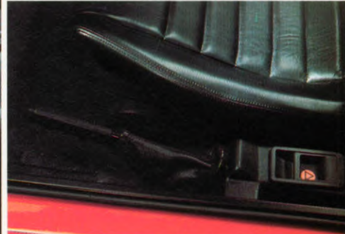
Mechanisch openen van het portier.
