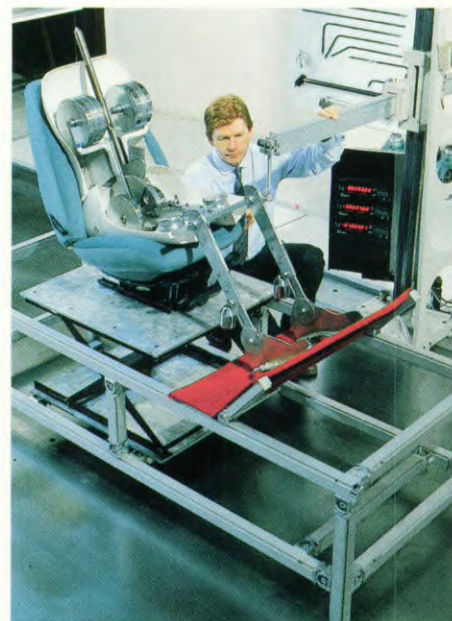
Onderzoek naar de ideale zithouding met behulp van een biomechanisch model.
