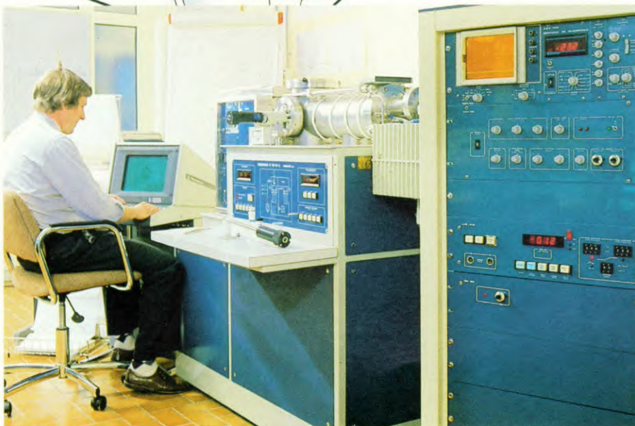
Analyse van stoffen door middel van een spectrometer, gekoppeld aan een chromatograaf.
