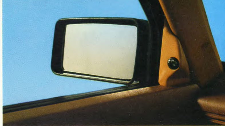
Zijspiegel, van binnen te bedienen
