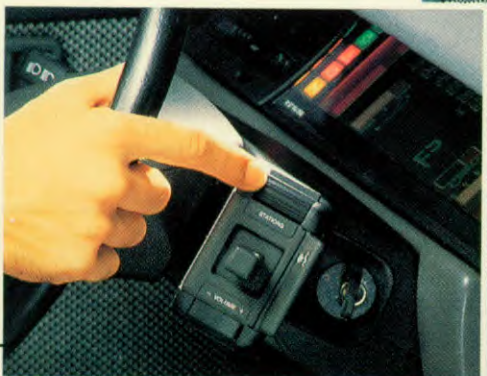
Parallelbediening radio aan de stuurkolom.
