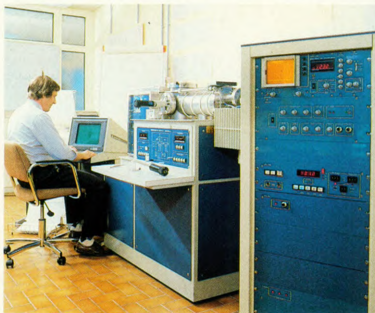
Spectrometer voor vaste stoffen, gekoppeld aan een chromatograaf voor gassen. Uniek in de Franse autoindustrie.
