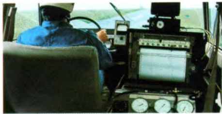
Prototypen van een nieuwe Renault zijn uitgerust met meetapparatuur. Door testrijders worden ze in de Hel van Renault afgebeeld, 24 uur per dag.
