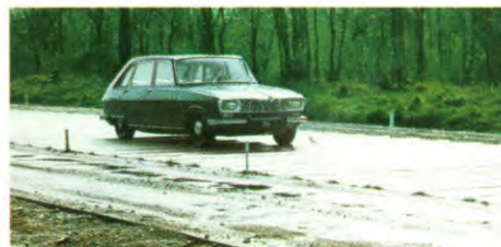
De weg van gegolfd beton. Gloeiend heet zomers, spiegelglad 's winters. Toch moeten de prototypen er met 140 km per uur overheen.
