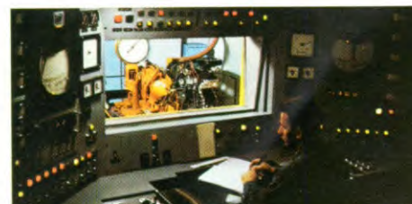
De beul achter het scherm. Onverstoorbaar noteert hij en verricht hij de metingen terwijl de Renaultmotor weken lang op topsnelheid draait.
