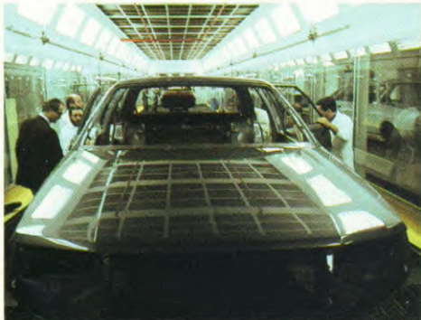
Controle van afdichting vóór het bekleden
