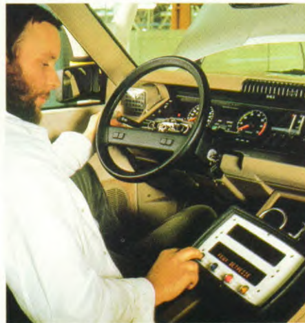
Geprogrammeerde controle van de elektrische functies
