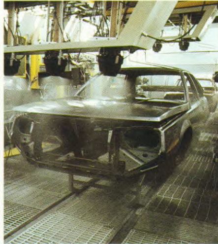
Het automatisch spuiten van laklagen
