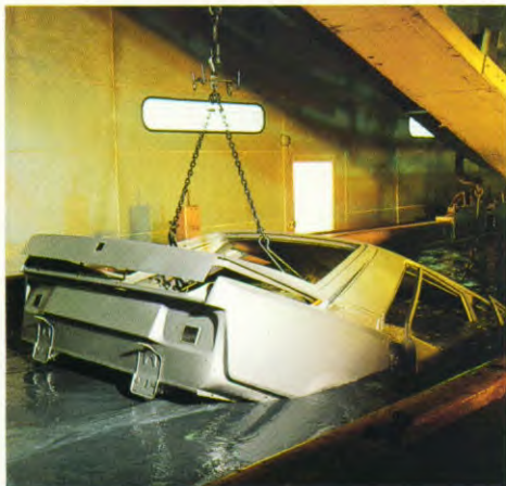
Dompelbad ▲ Lassen door een robot ▼
