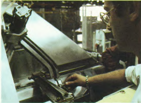
Controle van de toleranties op 90 punten
