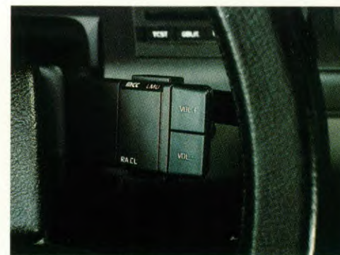
Bediening van de radio aan de stuurkolom.
