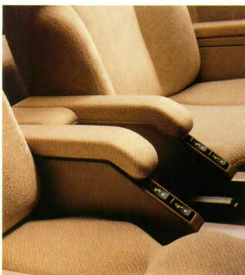
Centrale armsteun met elektrische bediening van de voorstoelen.
