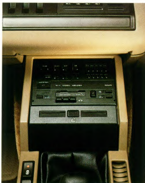
Radiopaneel: 4 x 20 Watt hifi-stereo versterker - autoreverse cassettespeler - tuner - balansregelaar.
