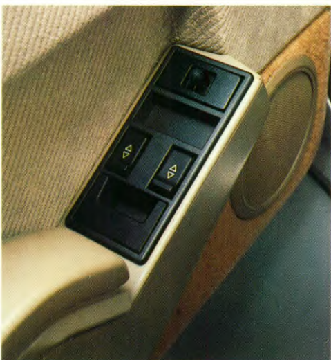
Elektrische zijruitbediening vóór.
