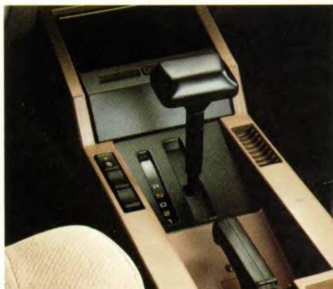
Bedieningshendel van de automatische transmissie.
