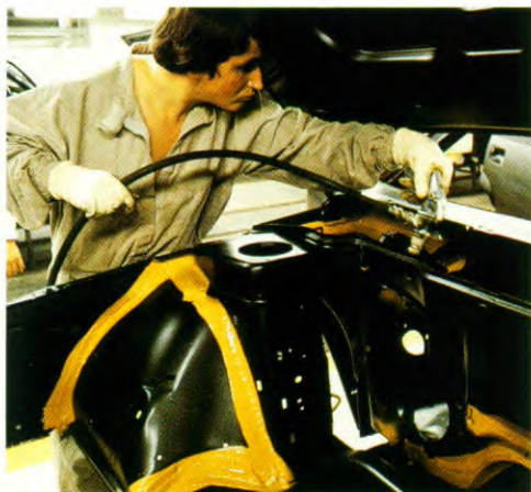
Het gladstrijken van de mastiek.
