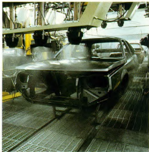
De lak wordt door robots gespoten.
