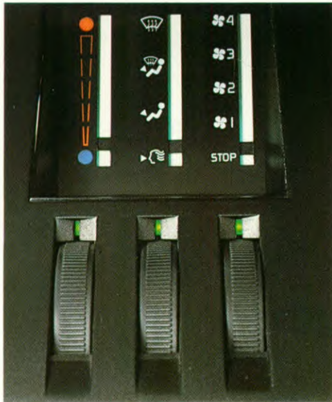
Bedieningspaneel verwarming en ventilatie.
