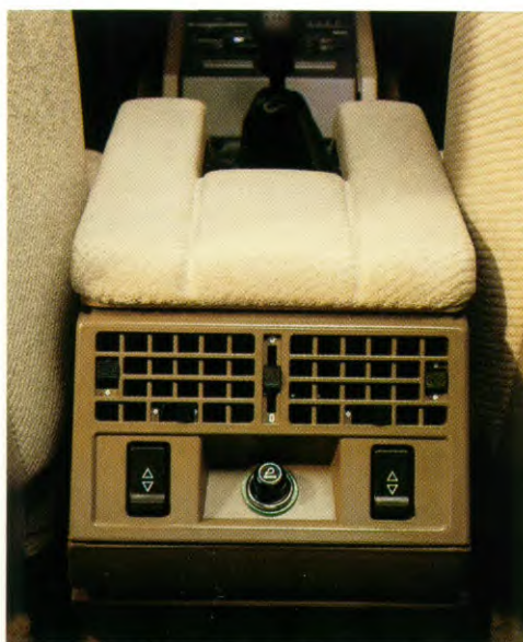
Achterconsole met uitstroomopeningen voor verwarming en apart regelbare ventilatie-openingen, asbak plus aansteker en elektrische zijruitbediening.
