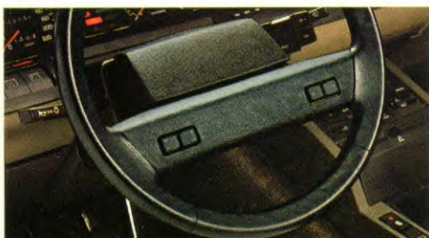
Bedieningsknoppen van de snelheidsregelaar.
