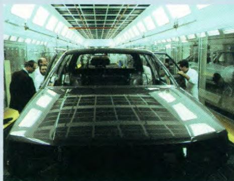
Controle van afdichting vóór het bekleden
