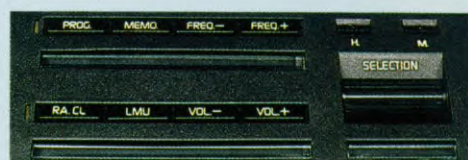
Geluidsinstallatie: 4 x 20 Watt hifi stereo versterker — cassettespeler met auto-reverse — ontvanger — equalizer.
