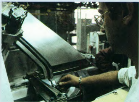
Controle van de toleranties op 90 punten
