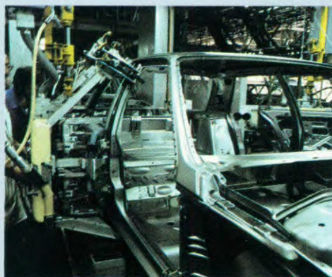
Meting bij assemblage van de portieren door robots
