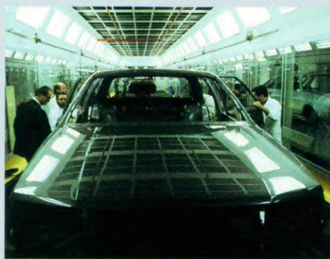
Controle van afdichting vóór het bekleden
