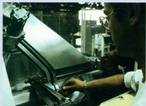
Controle van de toleranties op 90 punten
