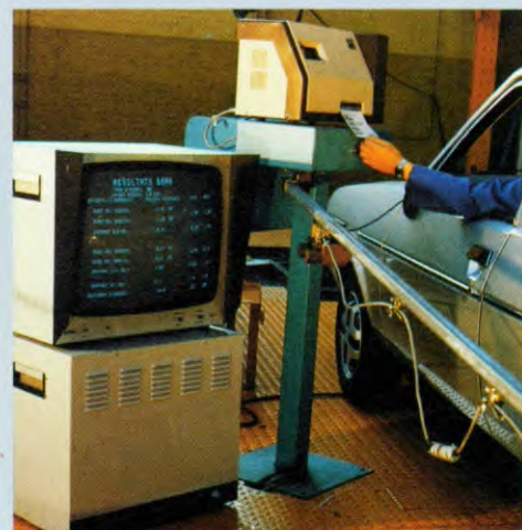
Geprogrammeerde controle van de elektrische functies
