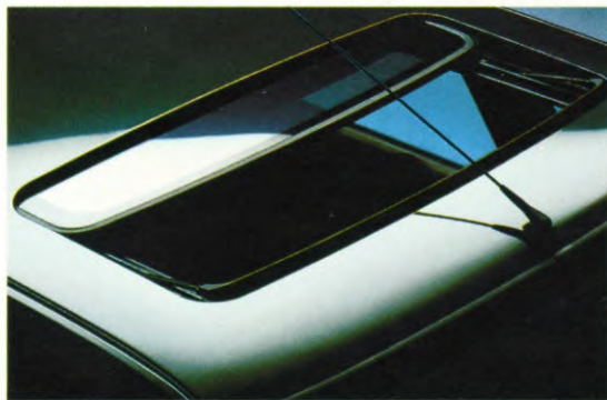
Elektrisch bediend zonnedak.
