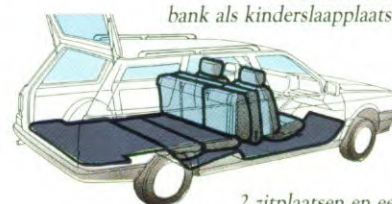
2 zitplaatsen en een laadvolume van 1694 dm 3 . Maximum laadlengte 1,705 m.
