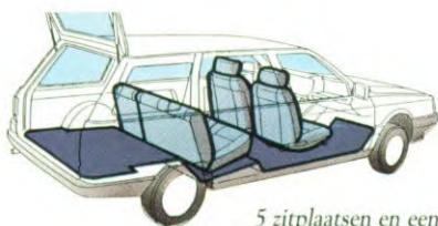
5 zitplaatsen en een laadvolume van 931 dm 3 . Maximum laadlengte 1,146 m.
