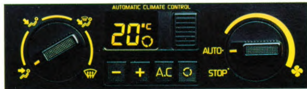
Airconditioning met elektronisch regelbare verwarming.
