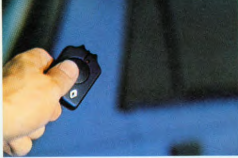
Elektrische portiervergrendeling (TXE) met afstandsbediening (comfort-pakket)
