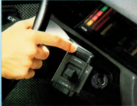
Parallelbediening radio aan de stuurkolom
