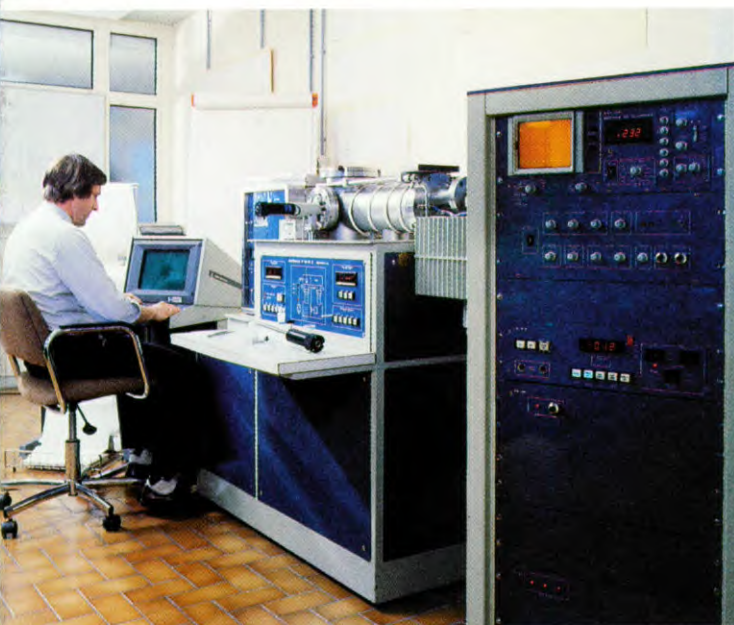
Spectrometer voor vaste stoffen, gekoppeld aan een chromatograaf voor gassen. Uniek in de Franse autoindustrie.
