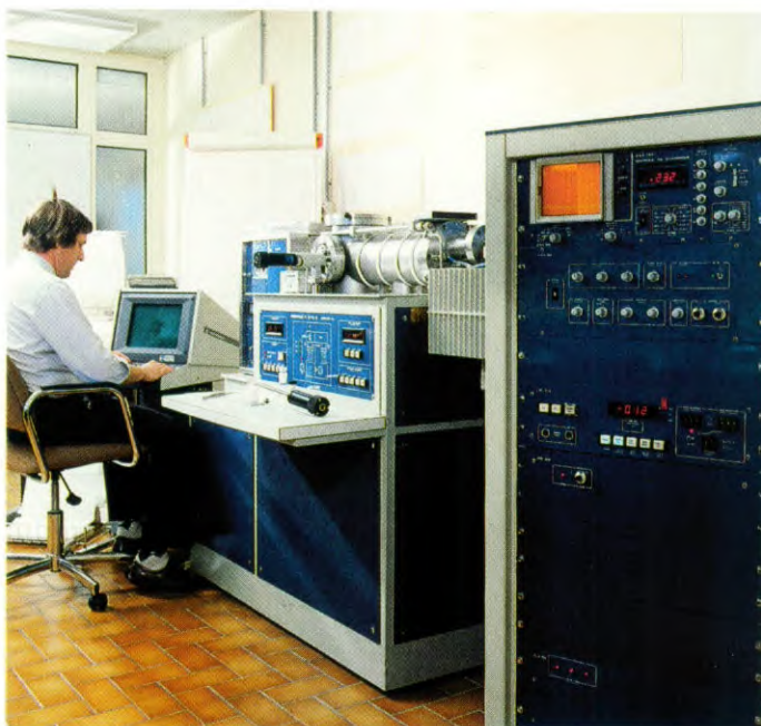
Spectrometer voor vaste stoffen, gekoppeld aan een chromatograaf voor gassen
