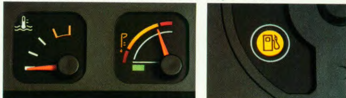
Watertemperatuur, oliepeil, waarschuwingslampje voor brandstofpeil
