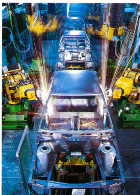
Robots lassen de carrosserie
