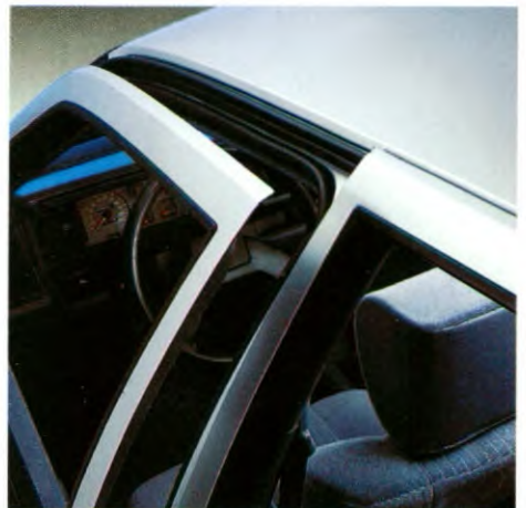
Portieraansluiting aan de carrosserie
