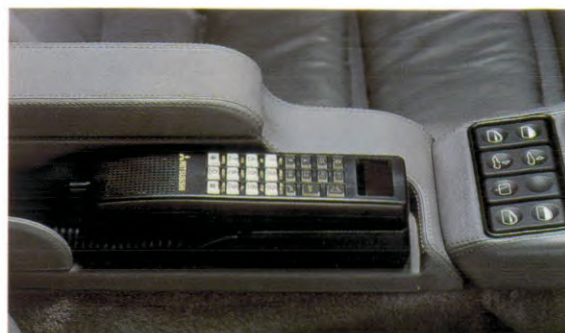
M612 Diese Variante des Telefoneinbaus schafft Platz für eine geschmackvolle Kassettenablage. • M612 The neatly installed Porsche Cellular system does not interfere with the cassette storage compartment.
