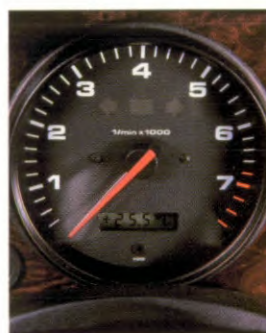
X57 Drehzahlmesser mit integriertem Außenthermometer • X57 Rev Counter integrated with outside temperature control.
