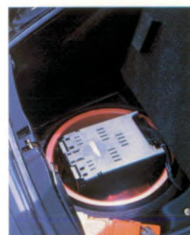
M612 Das Sendeempfangsgerät Philips Porty wird in die Reserveradvorrichtung integriert.
