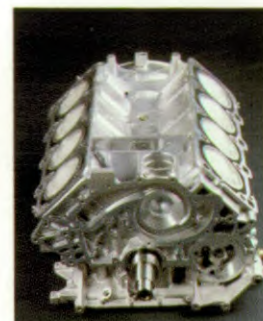
De met siliciumkristallen beklede cilinderwanden.
