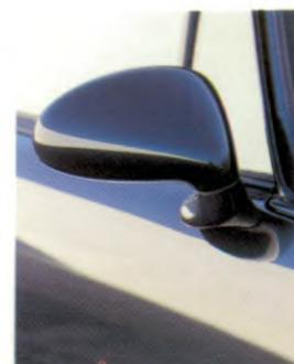
Verbeterde aerodynamica door nieuwe buitenspiegelvorm.
