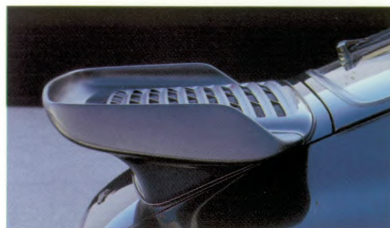
Karakteristieke, brede Turbo-achterzijde. De laadluchtcooler is in de vast gemonteerde spoiler geïntegreerd.
