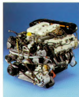
De lichtmetalen V8-motor van de 928 GT levert 243 kW.
