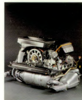
De nieuw ontwikkelde turbomotor in klassieke boxerconstructie.
