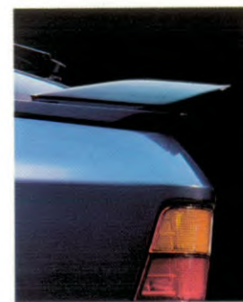
Verbeterde aerodynamiek en lagere liftkrachten door achterspoiler.
